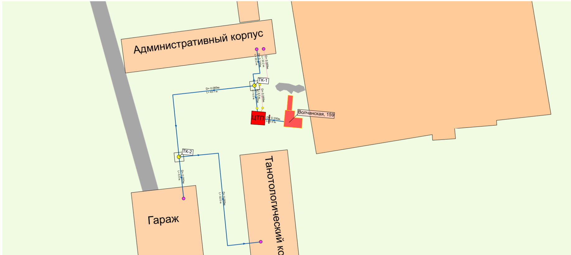
Рисунок 1.9.29 Схема магистральных сетей от котельной «Волчанская, д. 159»
