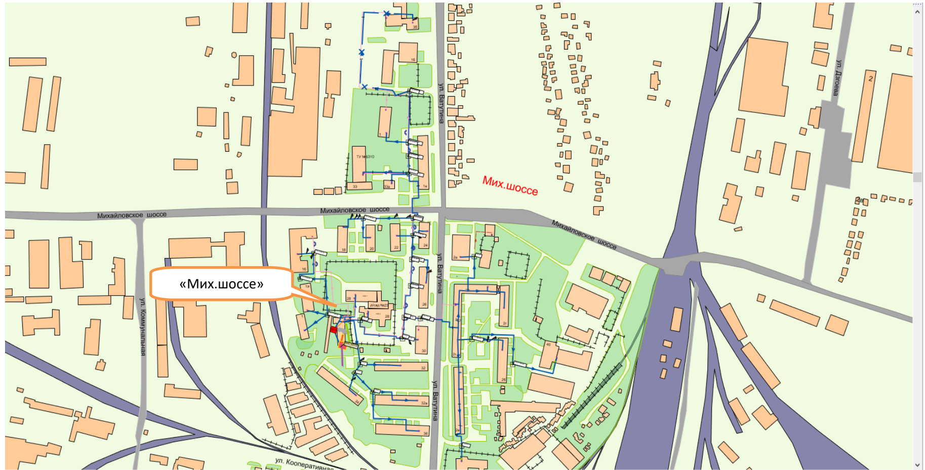
Рисунок 1.9.14 Схема магистральных сетей от котельной «Мих. шоссе»
