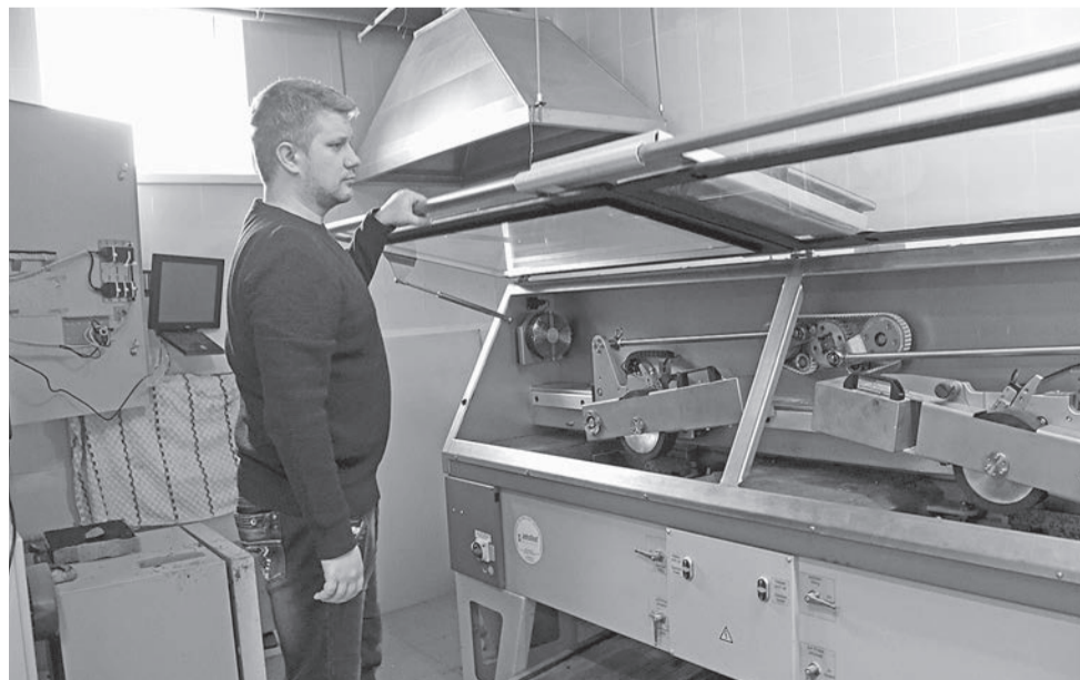
Старший научный сотрудник кафедры «Автомобильные и железные дороги» им. А.М. Гридчина Андрей Акимов с прибором для определения колебательности асфальтобетонной смеси.
