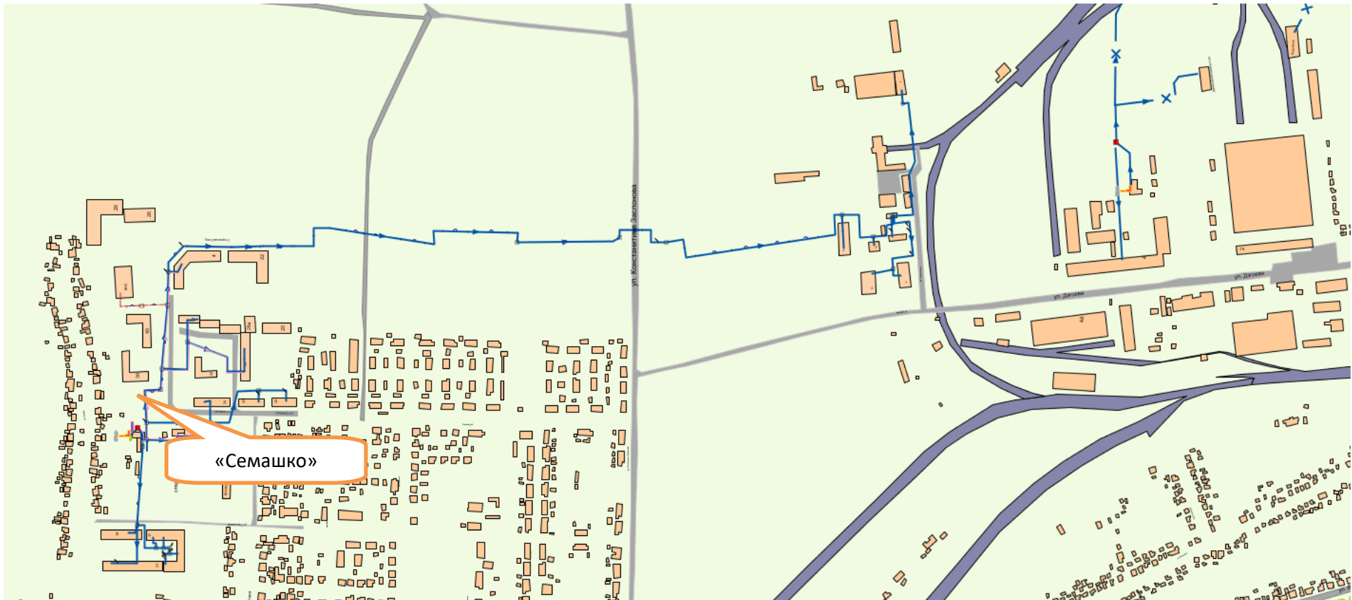
Рисунок 1.9.12 Схема магистральных сетей от котельной «Семашко»
