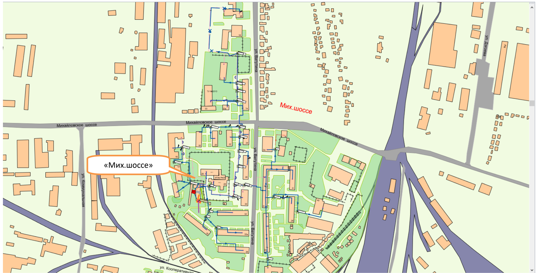
Рисунок 1.9.14 Схема магистральных сетей от котельной «Мих. шоссе»
