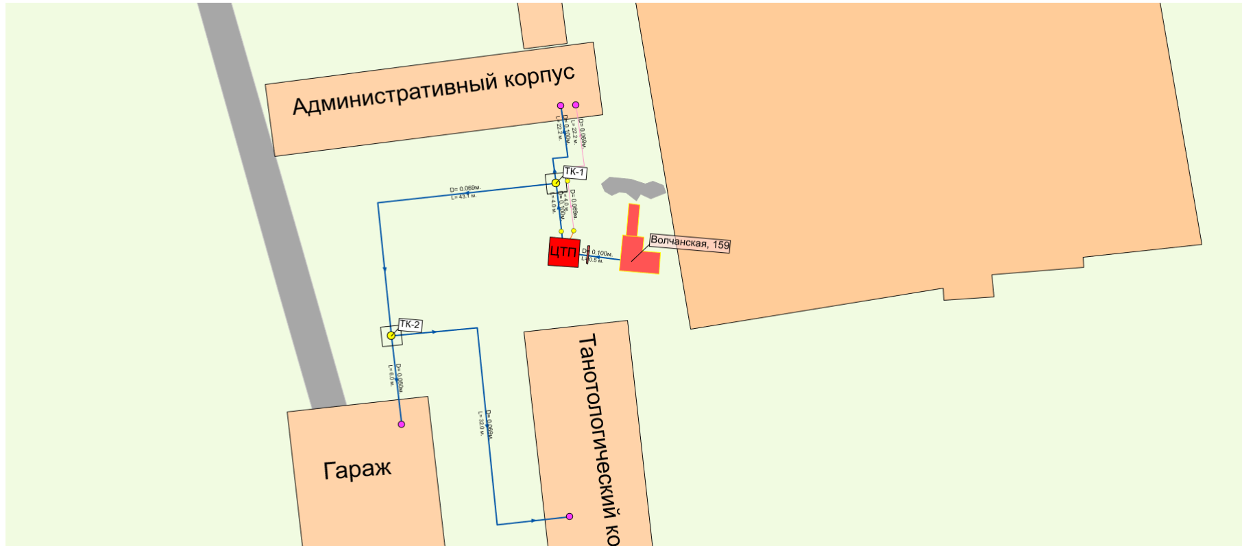
Рисунок 1.9.29 Схема магистральных сетей от котельной «Волчанская, д. 159»
