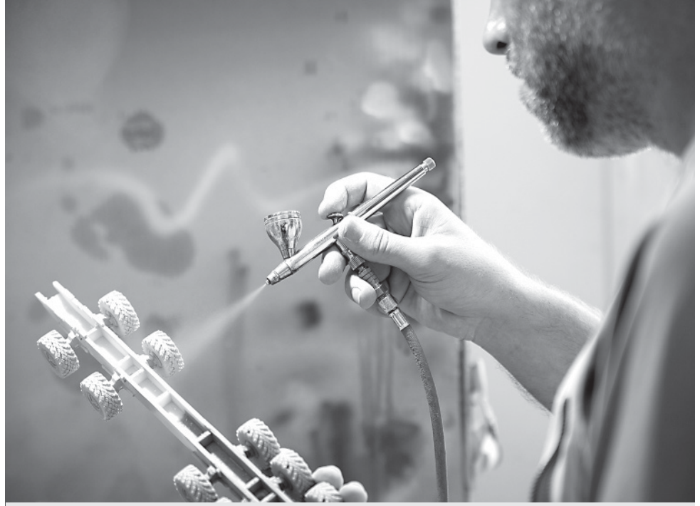
Окраску макетов производят вручную с помощью аэрографа.
