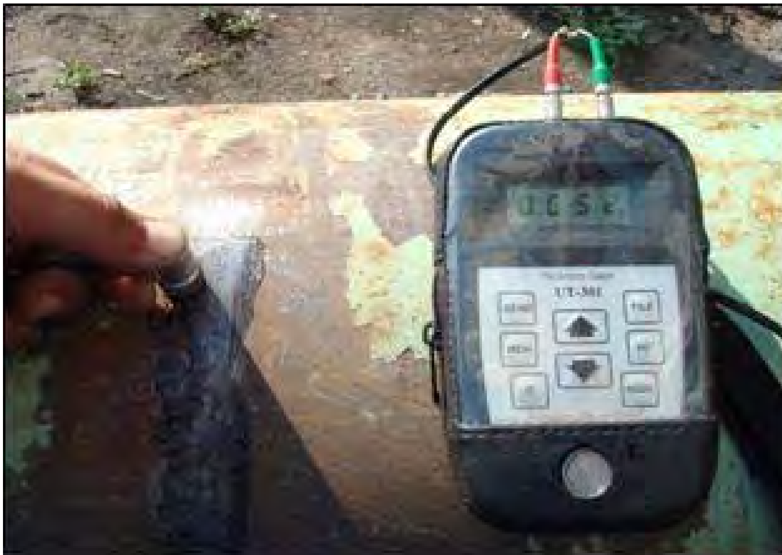
Фото 2. Замер фактической толщины стенок трубопровода с помощью ультразвукового толщиномера УТ-301.
