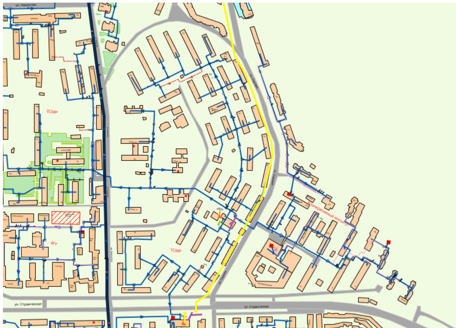
Рисунок 1.9.4 Схема магистральных сетей от котельной «1 CMP»
