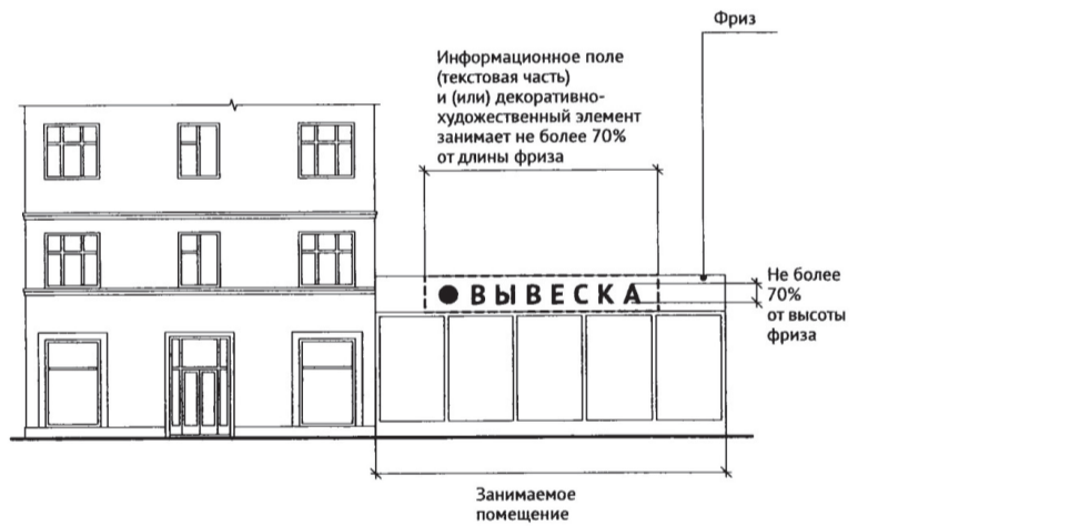
Рисунок 25. При наличии на фасаде здания, строения сооружения козырька настенная вывеска может быть размещена на фризе козырька строго в габаритах указанного фриза (пункт 6.5.8 Правил).
