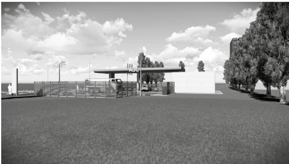
Ограждение мусорных контейнеров и контейнеров хранения топлива Ограждение из негорючих материалов в виде продуваемых преград с отношением площади отверстий к общей площади не менее 50%. Высота ограждения – 2м.
