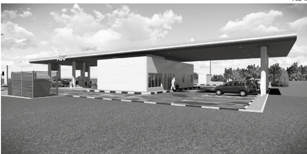
Ограждение мусорных контейнеров и контейнеров хранения топлива Ограждение из негорючих материалов в виде продуваемых преград с отношением площади отверстий к общей площади не менее 50%. Высота ограждения – 2м.
