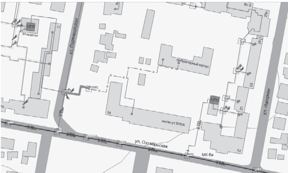
Реконструкция тепловых сетей от ТК-1-1/166 до жилого дома по ул. Садовая, 102 (2 магистраль) Рис. 1.17
