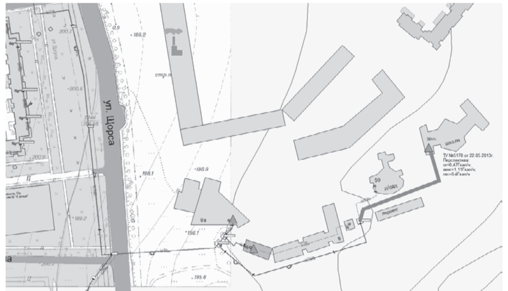
Реконструкция тепловой сети от ТК -1/1-Гор.1 до УТ-1 (проект) с увеличением диаметра с 2d76 мм на 2d108 мм Рис. 1.21
