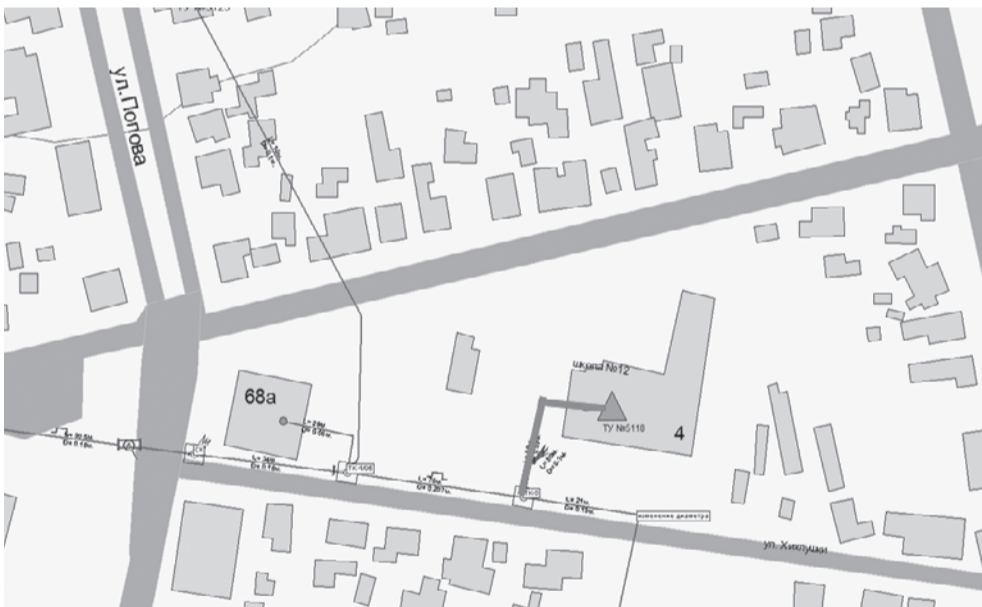
Для подключения перспективных потребителей к 2 магистрали Белгородской ТЭЦ с суммарной тепловой нагрузкой 12,293 Гкал/час необходимо выполнить переключение части потребителей 3 ЮМР на контур котельной «Южная» с подключением в МК-8 и МК-10 пятой магистрали. (Переключаемая тепловая нагрузка 3 ЮМР составит 12,261 Гкал/час) Рис. 1.19
