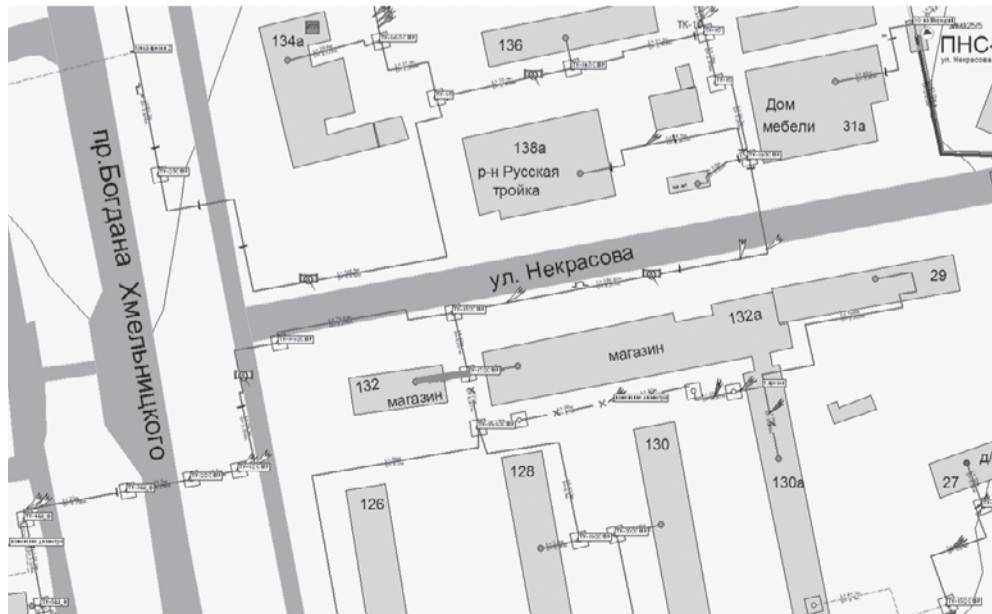
Реконструкция участка тепловой сети от ТК 17 - 2СМР до ИТП пр. Б. Хмельницкого, 132 (2 магистраль) Рис. 1.15
