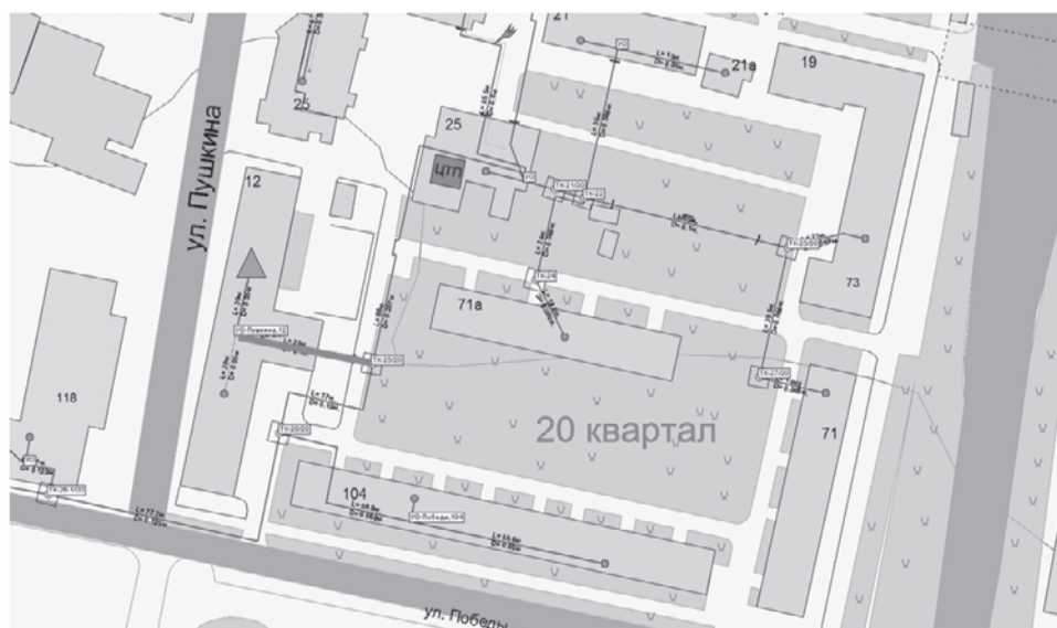
Переустройство тепловых сетей от ТК 25/20 до ул. Пушкина, 12 (1 магистраль) Рис. 1.10
