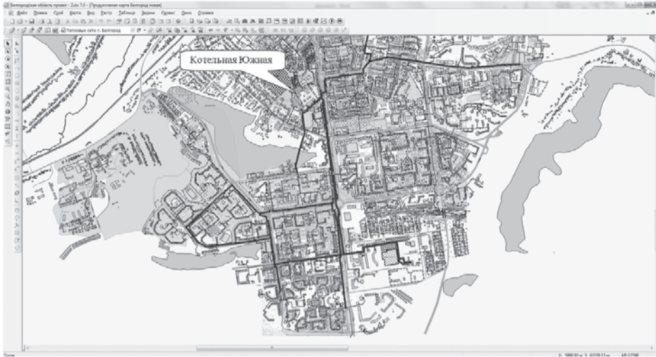
Электронная модель системы теплоснабжения от котельная «Западная»
