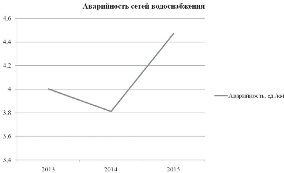
Рисунок 3.1.2.1 Аварийность сетей водоснабжения города Белгород
