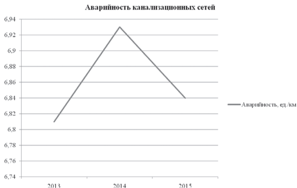
Рисунок 2.1.3.1 Аварийность канализационных сетей города Белгород
